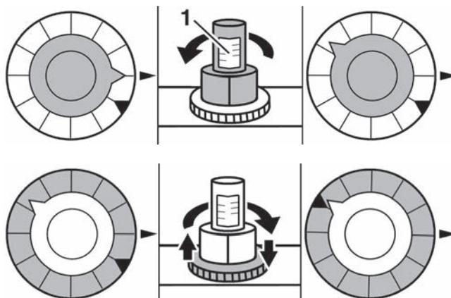
Ce réglage permet de mémoriser la répartition hydraulique du circuit tout en permettant le sectionnement du débit en cas de besoin.
