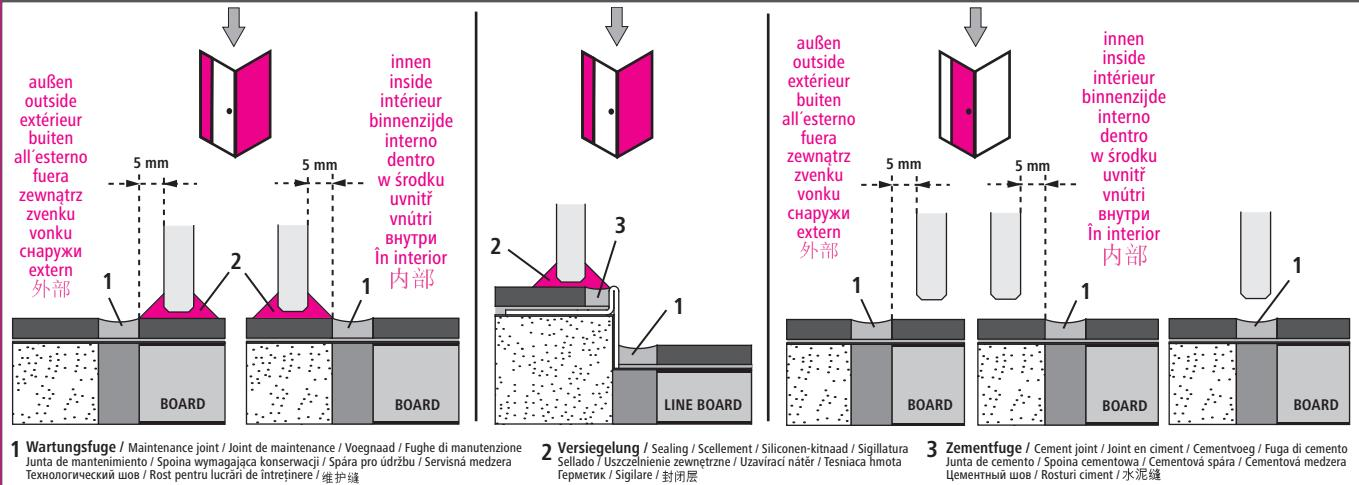
Vor Montagebeginn / before starting the installation / Avant la pose / voor start montage / Prima del montaggio
