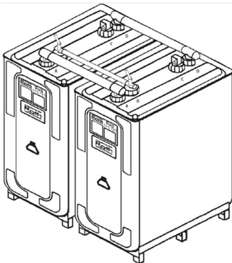
**ATTENTION : Une ventilation des réservoirs est obligatoire** pour permettre lors du soutirage du produit stocké un équilibre de pression par une entrée d'air et éviter une déformation de la cuve. (Idem lors du remplissage par raccord pompier, pour permettre l'évacuation de l'air).
