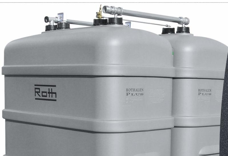
Les réservoirs ROTHALEN PLUS avec cuvette de rétention PE HD (enveloppe secondaire) sont conçus pour stocker des produits pétroliers, dont le point d'inflammation est > à 55°C. La cuvette de rétention en PE HD teintée dans la masse empêche l'altération du réservoir interne et du produit stocké par agression de rayons UV. Afin d'éviter les risques de déplacement du réservoir sous l'effet du vent, des eaux ou des trépidations, celui-ci doit être fixé solidement sur un sol plan maçonné.
