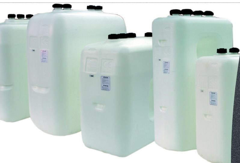
Les réservoirs ROTHALEN sans cuvette de rétention sont conçus pour stocker des produits pétroliers à l'intérieur dans local. Réservoir polyéthylène simple enveloppe, ils doivent être placés dans un bac de rétention étanche, dont la capacité est au moins égale à celle du stockage. Les réservoirs doivent être placés sur un sol plan maçonné fixés solidement su celui-ci s'ils sont installés en zone inondable ou en zone de sismicité.
